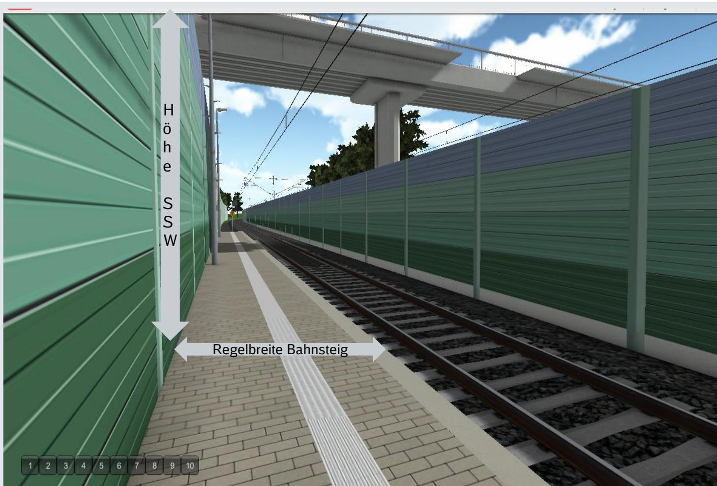
Am Bahnsteigbereich entstehen trotz regelkonformer Planung optisch eingeschnürte Räume, bedingt durch die Längsentwicklung des Bahnsteiges sowie der Höhe der Schallschutzwände
